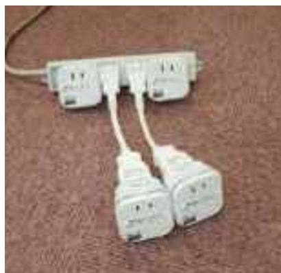
電力消費量を計測するセンサー。約250個のセンサーで収集したデータは無線通信によってサーバに送信され、ビッグデータとして蓄積されています。
