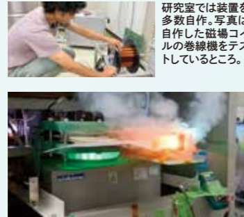
SACLAでの実験の様子。PINK-01が強い磁場を作って爆発しています。煙は液体ヘリウムによる冷却で生じた湯気です。そこに画面右からX線レーザーが照射されています。
